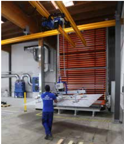
Das moderne Hochregallager wird in einem weiteren Ausbauschritt die Laseranlage automatisch beschicken
