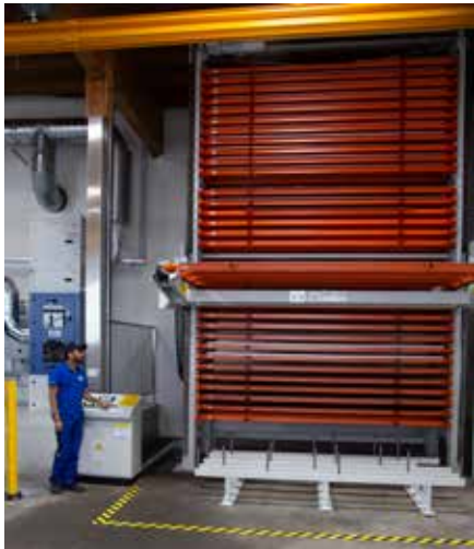
Das moderne Hochregallager wird in einem weiteren Ausbauschritt die Laseranlage automatisch beschicken
