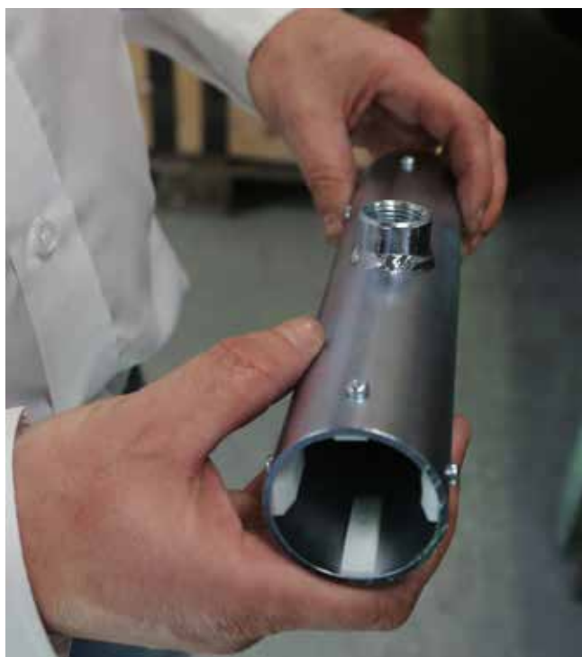
Anspruchsvolle Teile/Rohrsegmente gelocht und/oder mit Gewindenbohrungen versehen erfordern moderne Fertigungsverfahren.
