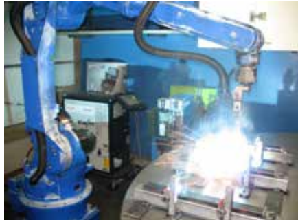
Qualitäts-Schweißungen manuell (TIG) und/oder mechanisiert am Roboter (MAG) je nach Werkstoff (schwarz S235 oder weiss 1.4301)
