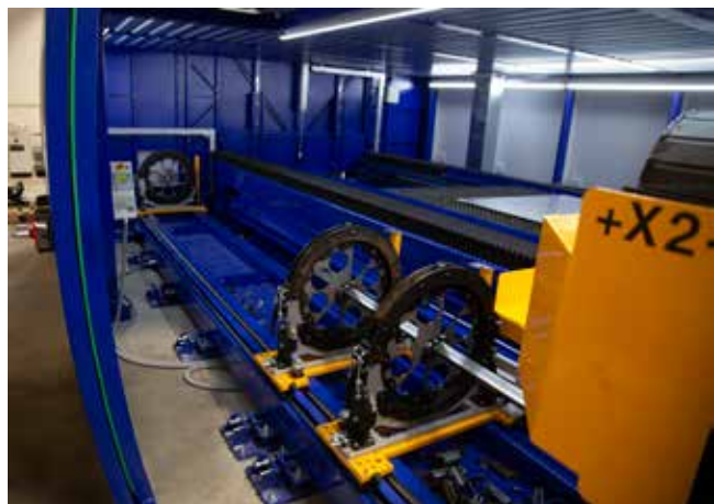
Blick in die Rohrlasereinrichtung. Das Stangenmaterial wird nach Abarbeitung der ersten 3 m um weitere 3 m automatisch nachgeführt.
