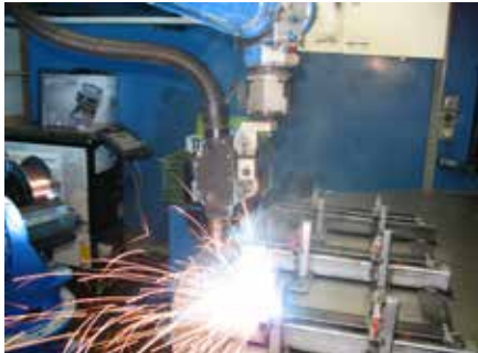
Qualitäts-Schweißungen manuell (TIG) und/oder mechanisiert am Roboter (MAG) je nach Werkstoff (schwarz S235 oder weiss 1.4301)
