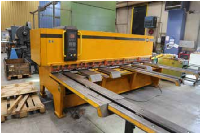
Schlagschere kompakter Bauart für grosse Abmessungen
