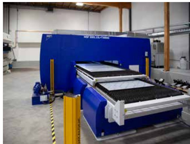
Der Wechseltisch der Anlage erlaubt kontinuierliches Schneiden in der Anlage bei gleichzeitiger Entnahme der geschnittenen Teile ausserhalb.
