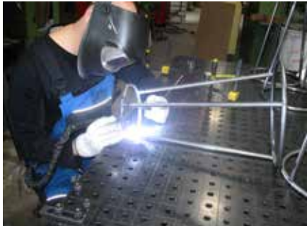
Qualitäts-Schweißungen manuell (TIG) und/oder mechanisiert am Roboter (MAG) je nach Werkstoff (schwarz S235 oder weiss 1.4301)
